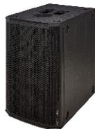
dB Technologies SUB 612, mit 12" Tiefton-Lautsprecher, 2,5" V.C., Class-D Digitalverstärker, 600 Watt/RMS, 1200 Watt/Peak, max SPL 129 dB, Frequenzgang 46 - 123 Hz, DSP 28/56 Bit, Eingang 2x XLR, Ausgang 2x XLR, M20 Stativgewinde, 1x Tragegriff, Sperrholz Gehäuse
